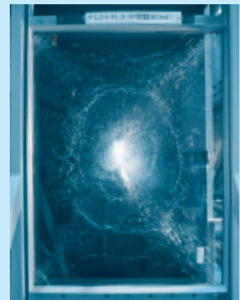
図7 FL3+60mil+FL3 （膜切れなし、貫通なし）
