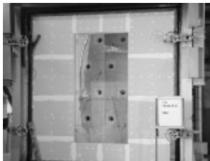
写真1 防火設備の性能確認試験例
