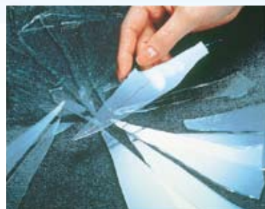
■フロート板ガラスの割れ方
