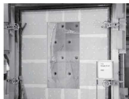
写真 1 防火設備の性能確認試験例
