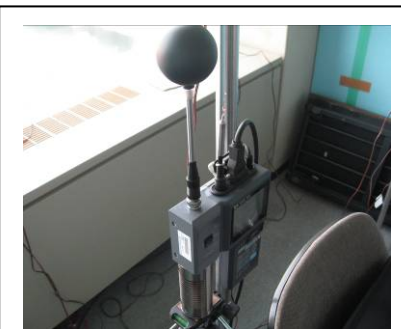
写真 1-6 PMV 計設置状況
