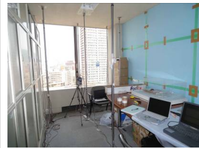
写真 1-5 室内温度測定状況
